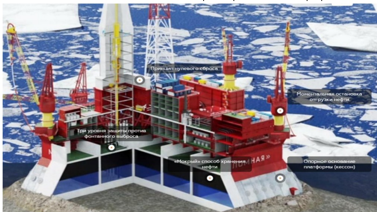
Рис.4. Установка на дне платформы «Приразломная» [12]
